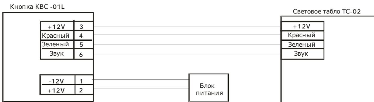
Рисунок 3-Схема электрических соединений
