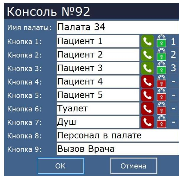
Рисунок 4.27. Окно изменения параметров системного контроллера
